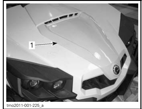
1. Tampa de manutenção
