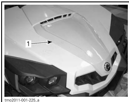
1. Tampa de manutenção
