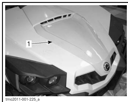
1. Tampa de manutenção
