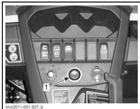
1. Botón de arranque del motor
