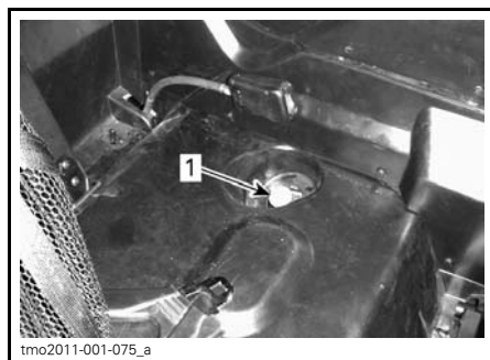
1. Varilla medidora del nivel de aceite
