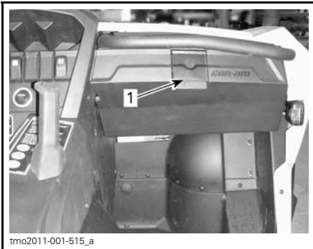
1. Cierre de seguridad de la guanterera
