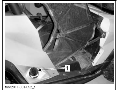
1. Tapón del depósito de combustible
