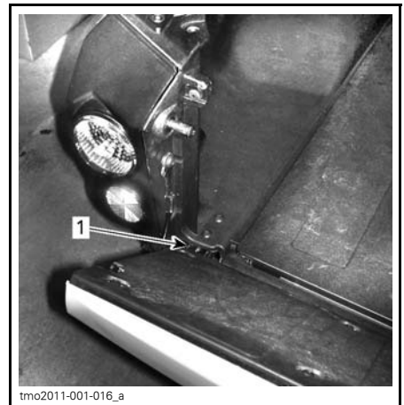
1. Bisagra de la puerta trasera superior
