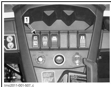
1. Interruptor de luces largas/cortas
