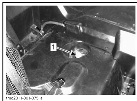
1. Varilla medidora del nivel de aceite
