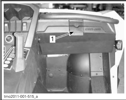
1. Cierre de seguridad de la guantera
