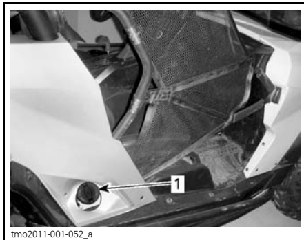
1. Tapón del depósito de combustible
