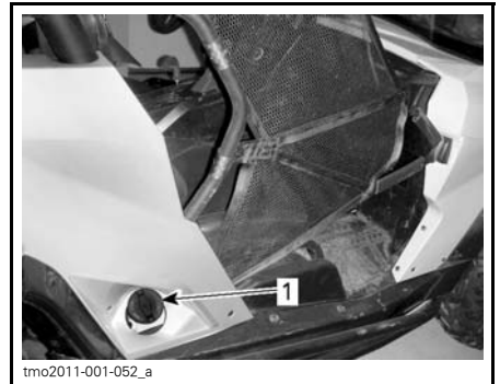
1. Tapón del depósito de combustible
