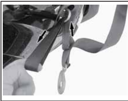
AJUSTE EL CABESTRANTE EN LA POSICIÓN DE "ENROLLAMIENTO"
