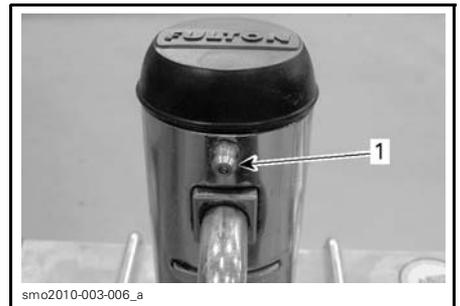
1. Raccord de graissage
