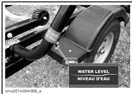
AUTOCOLLANT DE NIVEAU D'EAU
