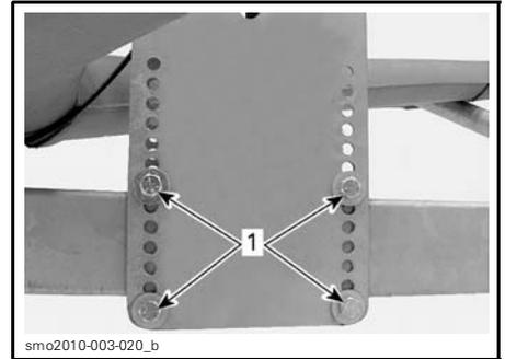
1. Boulons du support du mécanisme iCatch
