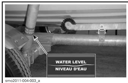
TYPIQUE - AUTOCOLLANT DE NIVEAU D'EAU
