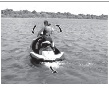
TYPBILD - STYRRIKTNINGEN OMKASTAD VID BACKNING
