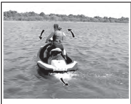
ТИПОВОЙ ВАРИАНТ – ИСПОЛЬЗУЙТЕ ПРОТИВОПОЛОЖНОЕ НАПРАВЛЕНИЕ ПОВОРОТА РУЛЯ ПРИ ДВИЖЕНИИ ЗАДНИМ ХОДОМ
