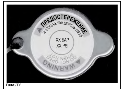
Наклейка «Горячая охлаждающая жидкость - не открывать»
