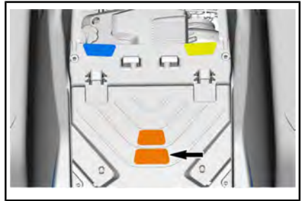
Наклейка «Горячая охлаждающая жидкость - не открывать»
