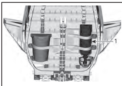
1. Extintor de incêndio
