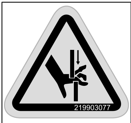
Pittogramma di protezione del portello iBR - Parte in movimento
