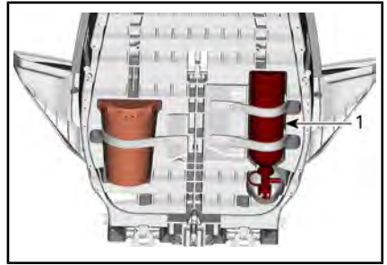
1. Extintor de incendios
