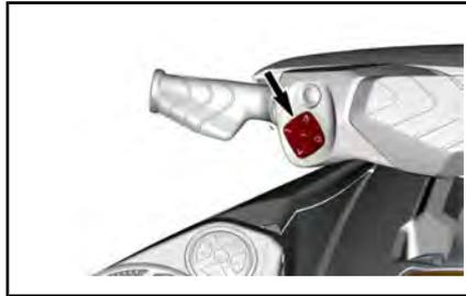
**Taste für das Variable Trimmssystem (VTS)**
