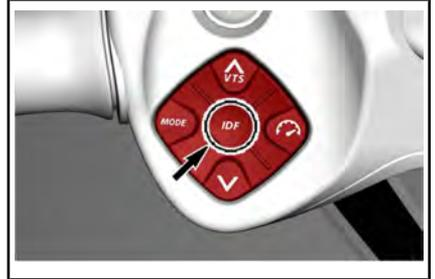
Ermöglicht die Betätigung des iDF-Systems. Siehe *VERWENDUNG DES INTELLIGENTEN VERSCHMUTZUNGSFREIEN PUMP-SYSTEMS* im Abschnitt *BEDIENUNGSANLEITUNG*.
