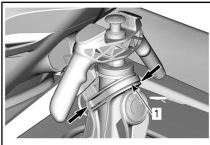
典型示例 - 向前推以解锁并拆下绳柱
