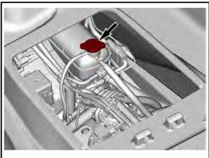
将摩托艇放在水平表面上，当发动机为冷机时，冷却液液位应处在冷却液储液罐的 MIN.（最低）和 MAX.（最高）标记之间。
