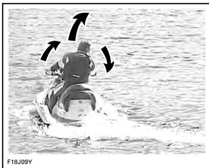
以喷射泵喷嘴中心转动控制摩托艇方向的手把。向右转动手把可让摩托艇向右和向左转向。转向需要加油门。
