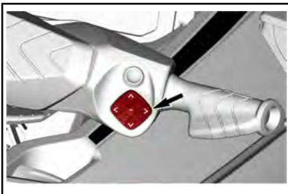
右侧控制器包含用于在多功能仪表中导航的控件。
