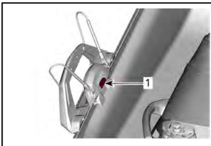
尾波滑水板齿条拆卸
