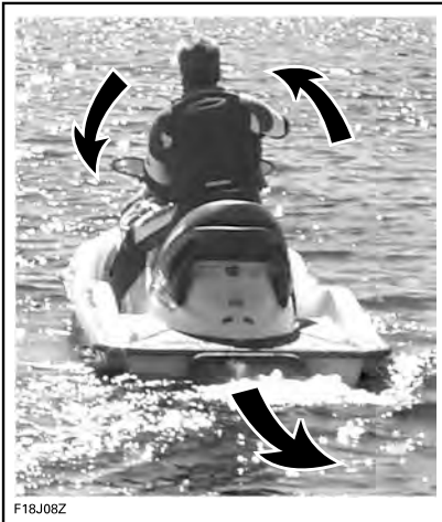
TYPBILD - STYRRIKTNINGEN OMKASTAD VID BACKNING
