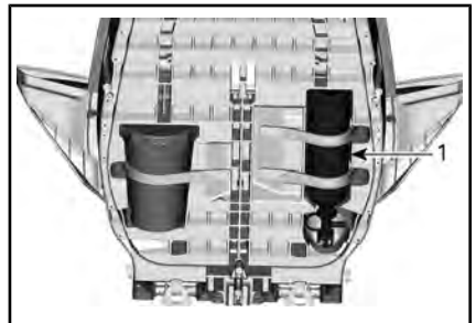
1. Extintor de incendios
