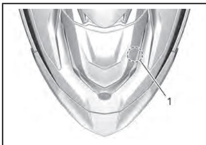
1. Плавкий предохранитель эхолота
