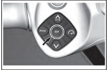
Позволяет активировать систему iDF. См. подраздел «ИСПОЛЬЗОВАНИЕ ИНТЕЛЛЕКТУАЛЬНОЙ СИСТЕМЫ УДАЛЕНИЯ МУСОРА ИЗ НАСОСА intelligent Debris Free» в разделе «ИНСТРУКЦИИ ПО ЭКСПЛУАТАЦИИ».
