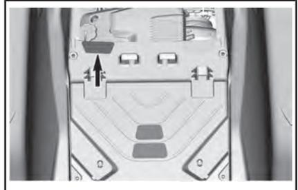
Ярлык, касающийся моторного масла и горячих компонентов
