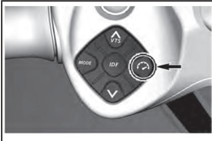
Permet de régler et de contrôler les fonctions liées à la vitesse.
