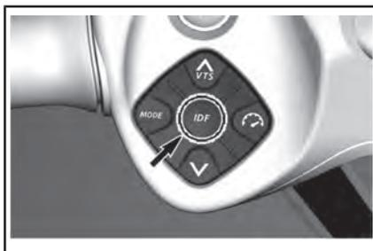
Il active le système iDF. Consultez *UTILISATION DU SYSTÈME DE POMPE INTELLIGENTE SANS DÉBRIS* dans la section *INSTRUCTIONS D'UTILISATION*.
