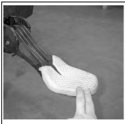
**ESTRIBO MANTIDO ABAIXADO PARA EMBARCAR DA ÁGUA**
