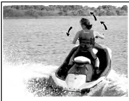
Virar o guidão gira o bocal da bomba de jato, que controla a direção da moto aquática. Virar o guidão para a direita vira a moto aquática para a direita. Virar o guidão para a esquerda vira a moto aquática para a esquerda. O acelerador deve ser usado para virar a moto aquática.
