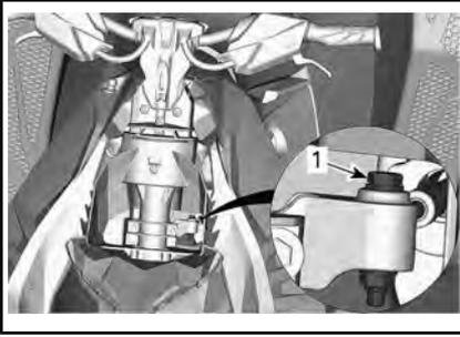
1. Parafuso de fixação do cabo de direção
