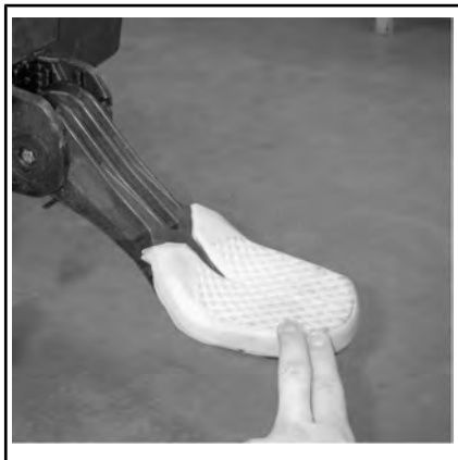
OMBORDSTIGNINGSTRINN HOLDT NEDE FOR Å KOMME OMBORD FRA VANNET
