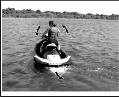
TYPEBILDE – STYRERETNINGEN ER MOTSATT NÅR DU RYGGER
