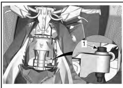
1. Boulon de fixation du câble de direction
