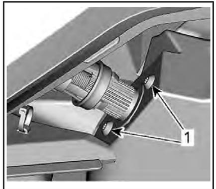
1. Tornillos del sistema de cables
