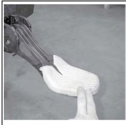
HERUNTERGEKLAPPTER AUFSTIEG-TRITT ZUM BESTEIGEN AUS DEM WASSER HERAUS
