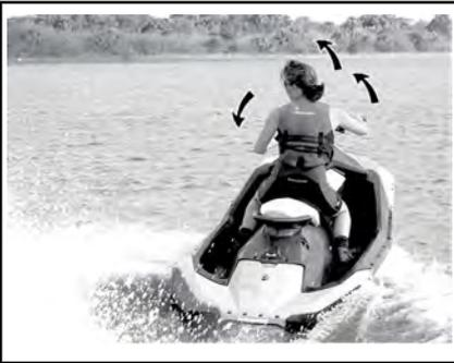
Durch Drehen des Lenkers wird die Strahlpumpendüse geschwenkt, wodurch wiederum die Fahrtrichtung bestimmt wird. Durch Drehen des Lenkers nach rechts steuern Sie das Wasserfahrzeug nach rechts. Durch Drehen des Lenkers nach links steuern Sie das Wasserfahrzeug nach links. Der Gashebel muss betätigt werden, um das Fahrzeug zu drehen.
