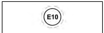
LOCALIZAÇÃO: PERTO DA TAMPA DO TANQUE DE COMBUSTÍVEL
