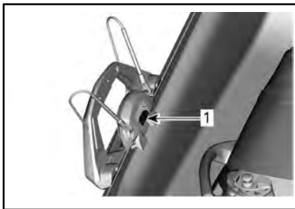
尾波滑木板齿条拆卸
