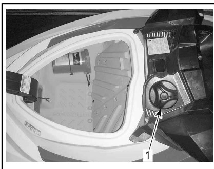
ТИПОВОЙ ВАРИАНТ – РАСПОЛОЖЕНИЕ КРЫШКИ ТОПЛИВНОГО БАКА
