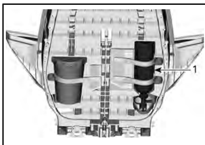
1. Extintor de incêndio
