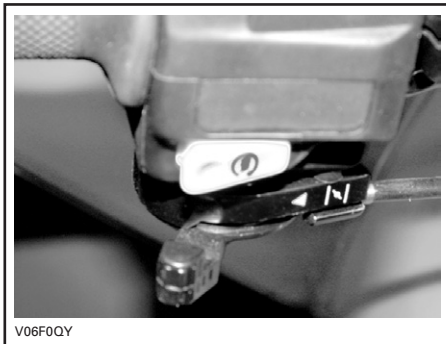
TYPISCH — CHOKEHENDEL IN MAXIMALE CHOKESTAND
