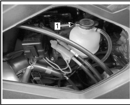
1. Tampa do tanque de expansão
