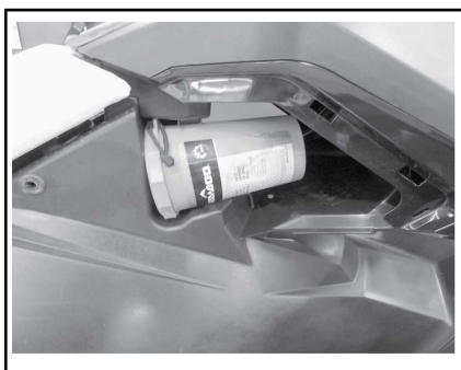
TYPISCH - RECHTERZIJPANEEL VERWIJDERD
