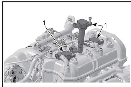
1. Bobinas de encendido
