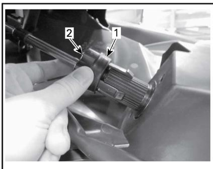
**CABLE DE DIRECCIÓN DESENGANCHADO**
