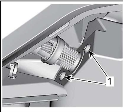
1. Tornillos del sistema de cables
