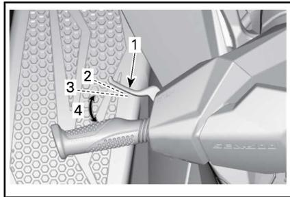
TÍPICA - PALANCA DEL SISTEMA iBR
