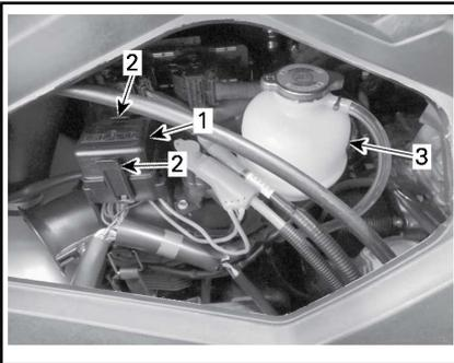
1. Cubierta de la caja de fusibles
