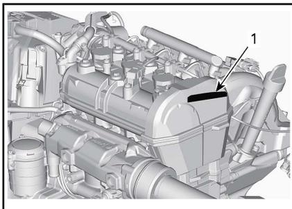
1. Identificación del fabricante del motor
