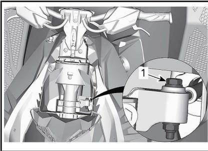
1. Perno de sujeción del cable de la dirección
