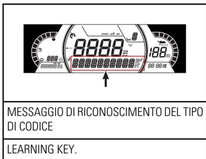
La modalità di apprendimento Sea-Doo limita la velocità dell'imbarcazione e la coppia del motore, consentendo in questo modo agli utilizzatori neofiti e ai conducenti meno esperti di imparare a usare l'imbar-
