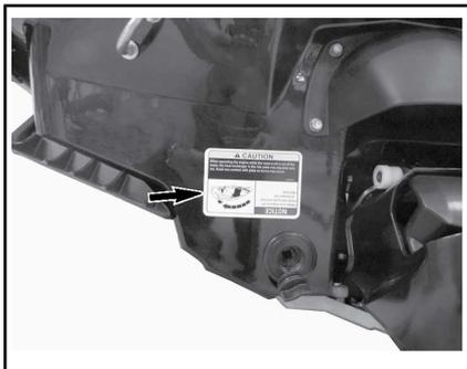
Questo motore è dotato di un sistema di protezione in caso di ribaltamento (T.O.P.S.™). In caso di capovolgimento dell'imbarcazione, il motore si arresta automaticamente.
