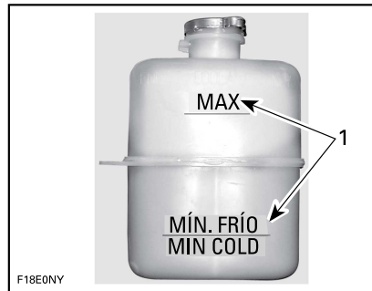
1. Nivel entre marcas cuando el motor está frío
