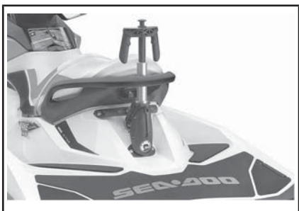
ТИПОВОЙ ВАРИАНТ — ПИЛОН ФАЛА ВОДНОЛЫЖНИКА/ВЕЙКБОРДИСТА ПОДНЯТ
