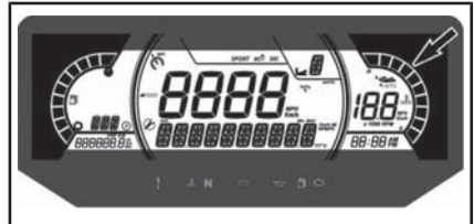
ИНФОРМАЦИОННЫЙ ЦЕНТР МОДЕЛИ GTR-X – ИНДИКАТОР ДИФФЕРЕНТА СИСТЕМЫ VTS
