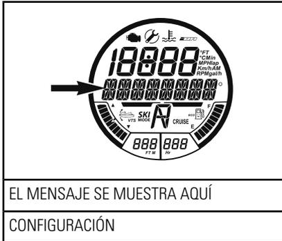
2. Pulse el botón ARRIBA o ABAJO repetidamente hasta que se muestre la función de RELOJ.
