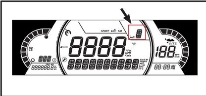
Hiermit wird die Position der Gearbox angezeigt:
