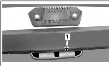
1. Hakenteil der Halterung an unterem Haltebeschlag
