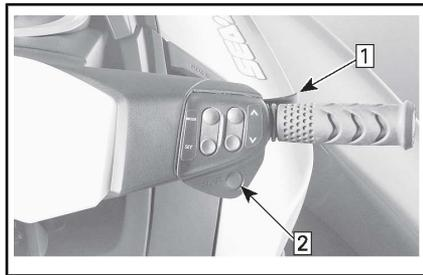
**TYPISCH - EINSCHALTEN DER GESCHWINDIGKEITSREGELUNG BEI FAHRGESCHWINDIGKEIT**
