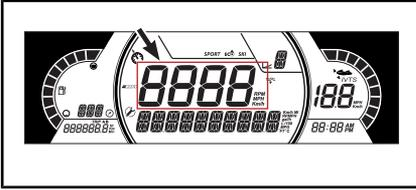
Die mittlere Anzeige zeigt die Geschwindigkeit des Fahrzeugs an.
