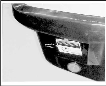
Der Motor des 4-TEC™ verfügt über einen Kippschutz (T.O.P.S.™). Wenn das Fahrzeug kentert, wird der Motor automatisch angehalten.
