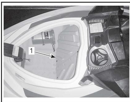
**ZUGRIFF AUF BATTERIE UND SICHERUNG, VORDERES STAUFACH**
