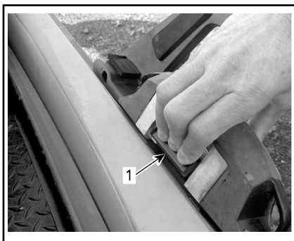
尾波滑水板齿条拆卸
