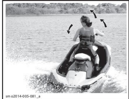
Перекладка штурвала приводит к повороту сопла водомёта в горизонтальной плоскости. Перекладка штурвала вправо приведет к повороту гидроцикла вправо, и наоборот. Во время выполнения поворота следует нажимать рычаг дроссельной заслонки.
