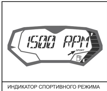
**ПРИМЕЧАНИЕ:** Индикатор спортивного режима будет гореть, пока включен спортивный режим. Если рычаг дроссельной заслонки не отпущен до конца, а двигатель не находится в режиме холостого хода спортивный режим не будет активирован. На дисплее отобразится следующее предупреждающее сообщение, отображаемое в виде «бегущей» строки:
