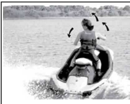
Girando il manubrio, l'iniettore della pompa a getto che controlla la direzione dell'imbarcazione gira su sé stesso. Girando il manubrio verso destra, l'imbarcazione gira a destra; girando il manubrio verso sinistra, l'imbarcazione gira a sinistra. Per girare l'imbarcazione, accelerare.
