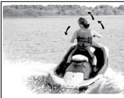
Al girar el manillar se hace pivotar la tobera de la bomba de impulsión que controla la dirección de la embarcación. Al girar el manillar hacia la derecha, la moto acuática girará hacia la derecha y a la inversa. Debe acelerar para girar la embarcación.
