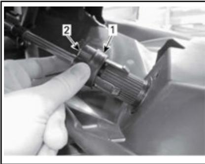
**CABLE DE DIRECCIÓN DESENGANCHADO**
