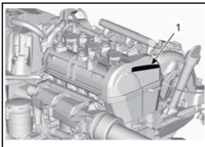
1. Identificación del fabricante del motor
