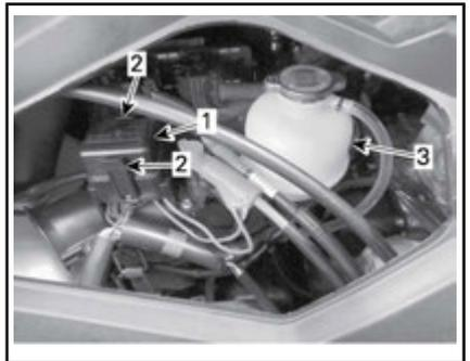
1. Cubierta de la caja de fusibles
