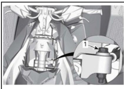
1. Perno de sujeción del cable de la dirección
