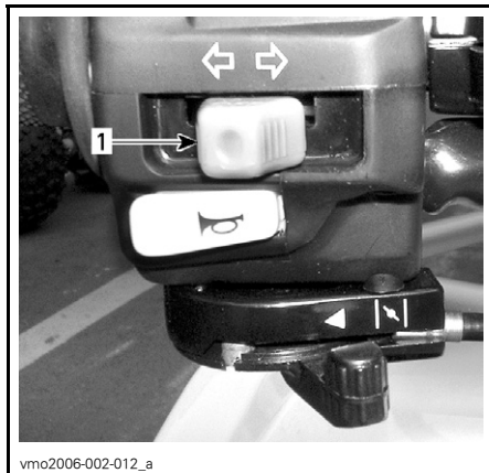
1. Schalter für Fahrtrichtungsanzeiger
