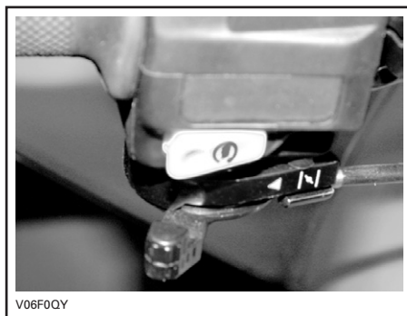
TYPISCH — CHOKE IN VOLLSTÄNDIG GEÖFFNETER POSITION (FULL)
