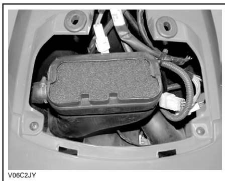
1. Deckel des Luftfilterkastens
