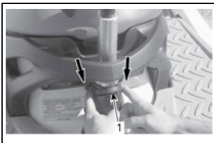
TYPBILD - TRYCK FRAMÅT FÖR ATT LÅSA UPP OCH TA BORT STÅNGEN
