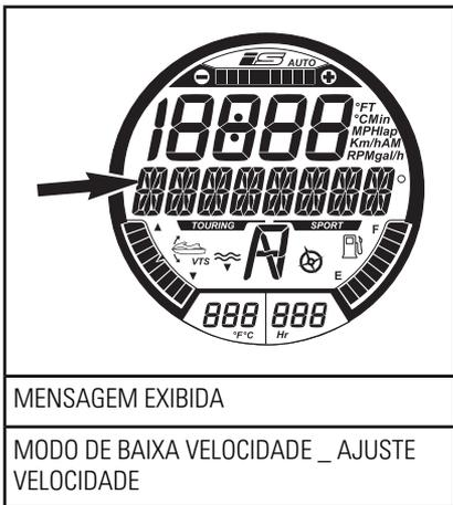
A indicação do ponto de ajuste na tela digital ficará ativa novamente para indicar a alteração da configuração de baixa velocidade.
