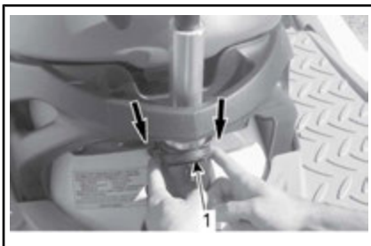
TYPEBILDE – SKYV MOT FREMRE DEL FOR Å LÅSE OPP OG TA AV STOLPEN
