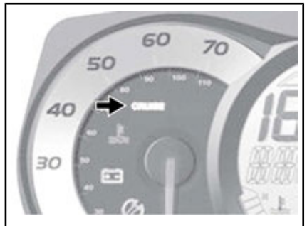
TYPEBILDE – INDIKATORLAMPE FOR CRUISEMODUS
