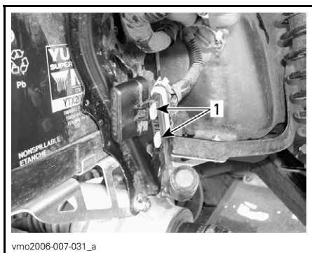
BAK — SÄKRINGARNAS PLATS 1. (F8) Huvudsäkring (30 A) (F9) Huvudsäkring, tillbehör (30 A)
