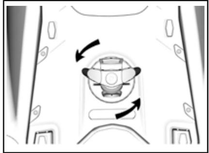
**AVVISO** È molto importante installare il coperchio del foro del pilone per prevenire infiltrazioni d'acqua nello scafo.
