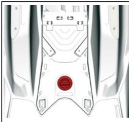
3. Rimuovere il coperchio di manutenzione del motore rimuovendo le relative viti.
