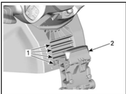
**CHIAVISTELLO DI REGOLAZIONE DELLA COLONNA DELLO STERZO CORRETTAMENTE FISSATO**
