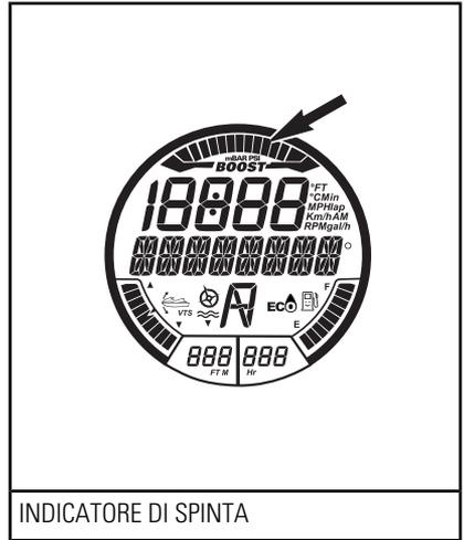
L'indicatore di spinta mostra la pressione di alimentazione del motore fornita dal sovralimentatore.
