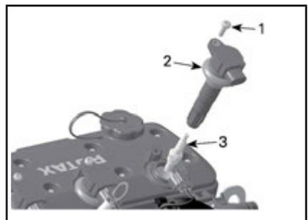
1. Vite di bloccaggio
