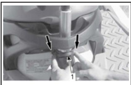
**CONFIGURAZIONE TIPICA - SPINGERE VERSO LA PARTE ANTERIORE PER SBLOCCARE E RIMUOVERE IL PILONE**
