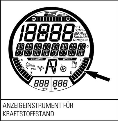
Wenn der Kraftstoffbehälter voll ist, sind 8 Segmente (Balken) der Anzeige aktiv. Das obere Segment wird nicht verwendet.
