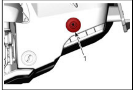
1. Plassering av slangetilkoblingen
