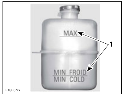
1. Nivå mellom merkene når motoren er kald
