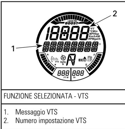
3. Confermare il funzionamento VTS cercando il movimento dell'indicatore di posizione VTS sul display digitale.
