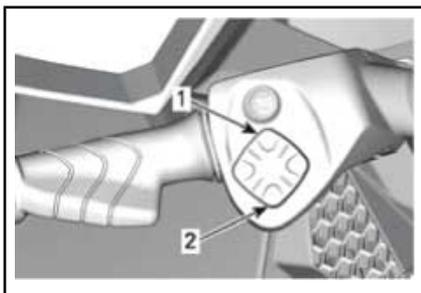
*CONFIGURAZIONE TIPICA - PULSANTE DI CONTROLLO VTS*
