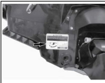
Il motore è dotato di un sistema di protezione in caso di ribaltamento (T.O.P.S.<sup>TM</sup>). In caso di capovolgimento dell'imbarcazione, il motore si arresta automaticamente.
