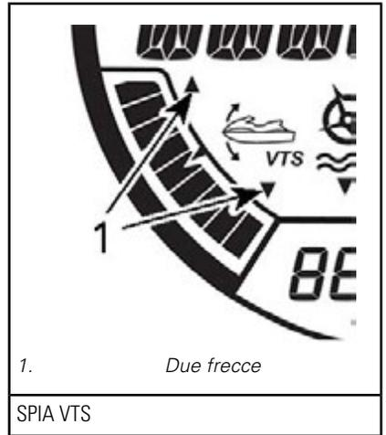
Quando la funzione Launch Control è attivata, le due frecce sull'indicatore non sono visibili.
