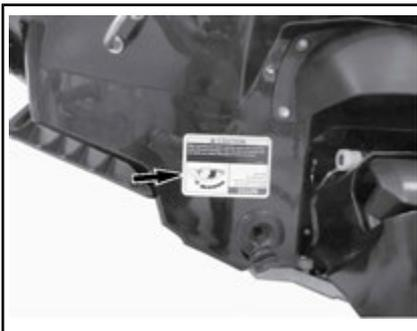
Ce moteur présente un système de protection en cas de chavirement (T.O.P.S.MC). Lorsque la motomarine chavire, le moteur s'arrête automatiquement.
